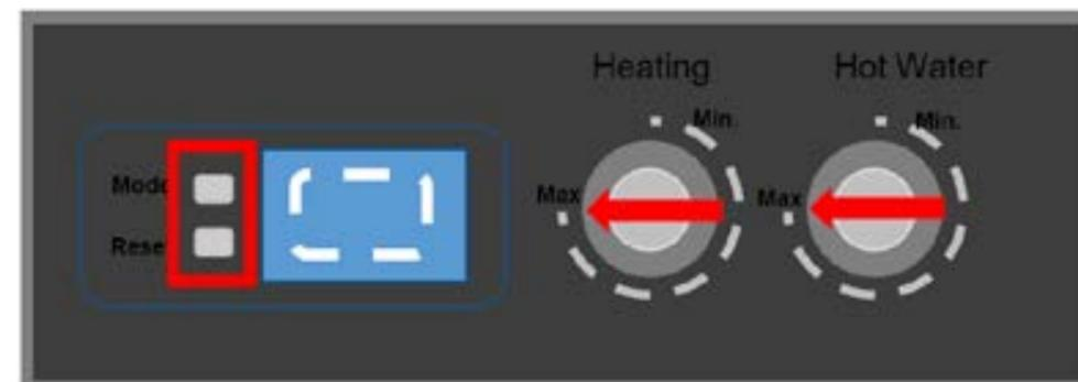
3. Когда появилась окружность, нажать на кнопку RESET на 3 секунды. На дисплее появится Au-to, означающее что процесс калибровки начался. Когда настройка закончится на экране появится P01 - параметр максимального давления газа (P00 - минимального давления газа).
