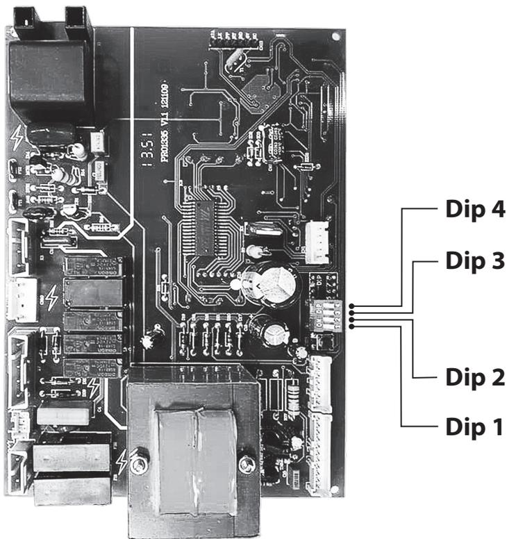
**Dip 1** Температура отопления
