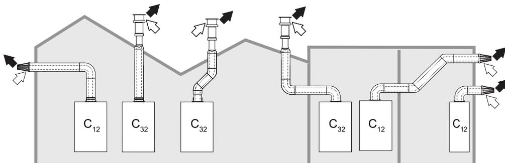
*Рис. 13 Пример систем дымоудаления собранных с помощью коаксиальных труб. Белой стрелкой обозначен приток воздуха, чёрной стрелкой отвод продуктов сгорания*
