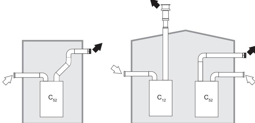
Рис. 15. Примеры систем дымоудаления собранных с помощью раздельных труб. Белой стрелкой обозначен приток воздуха, чёрной стрелкой поток продуктов сгорания
