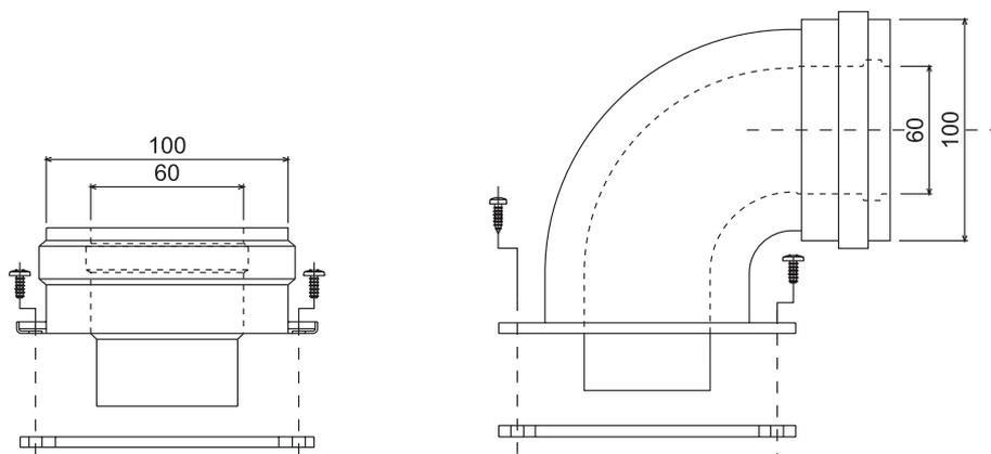
*Рис. 14. Элементы присоединения коаксиальной системы дымоудаления к котлу.
