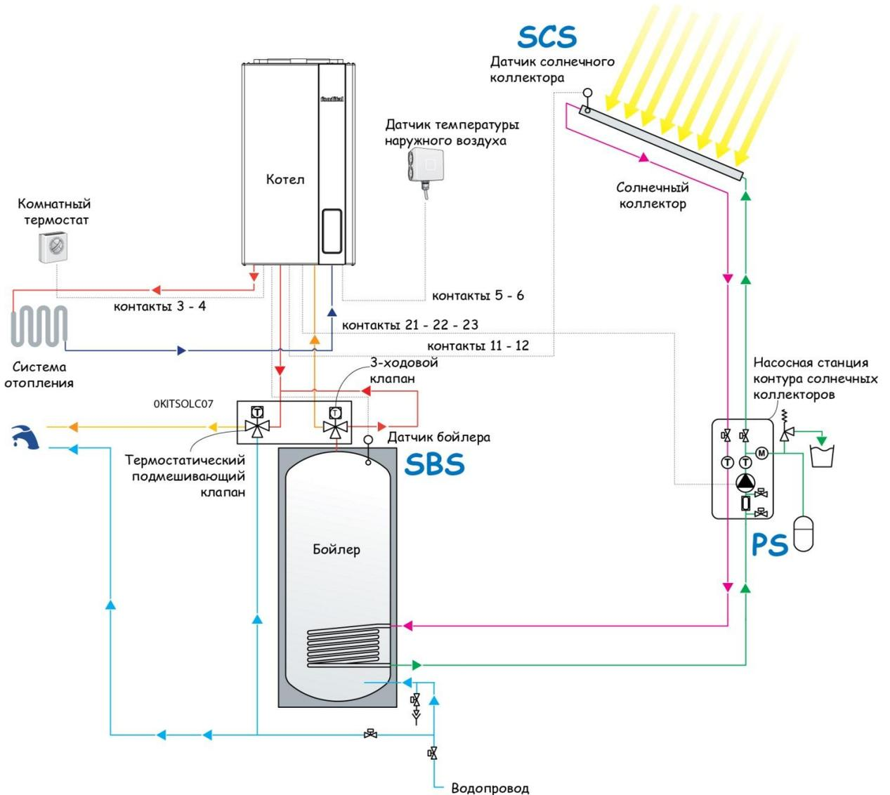
Задача котла в данном случае состоит в управлении насосом контура солнечных коллекторов посредством многофункционального реле для нагрева воды в бойлере. Для этого используются 2 температурных датчика, расположенных в солнечном коллекторе (SCS) и в бойлере (SBS)
