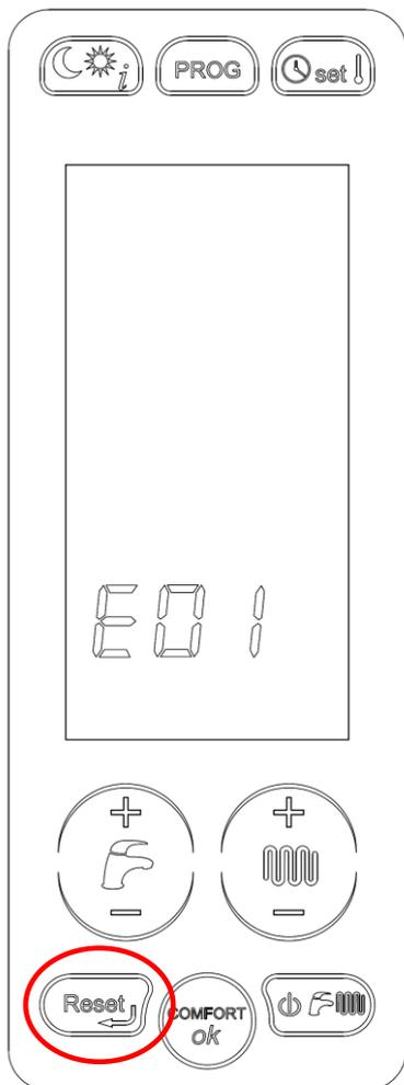
**Внимание:** в случае если котел может быть разблокирован автоматически, после исчезновения причины блокировки, на дисплее будет мигать только код неисправности. Если котел может быть разблокирован путем нажатия кнопки «reset», то будет активна и подсвечена только эта кнопка, а код неисправности будит гореть. После разблокировки котла, код неисправности исчезнет с дисплея и через минуту котел возобновит свою работу (без нажатия любых других кнопок), а дисплей отключится.
