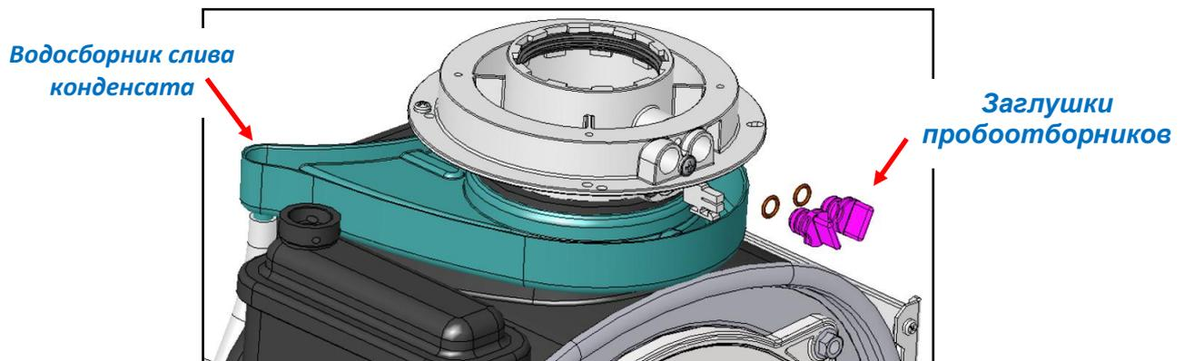
Между коаксиальным фланцем и первичным теплообменником устанавливается водосборник, задачей которого является отвод дождевой воды или конденсата, которые могут попадать в патрубок забора воздуха. Водосборник соединяется силиконовой трубкой с сифоном слива конденсата.
