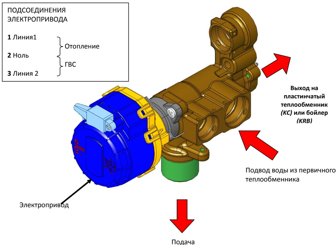
Вторичный теплообменник крепится к 3-ходовому клапану и другому узлу, выполненному из термополимеров, который соединяет трубу подвода холодной воды с остальными частями гидравлического узла.
