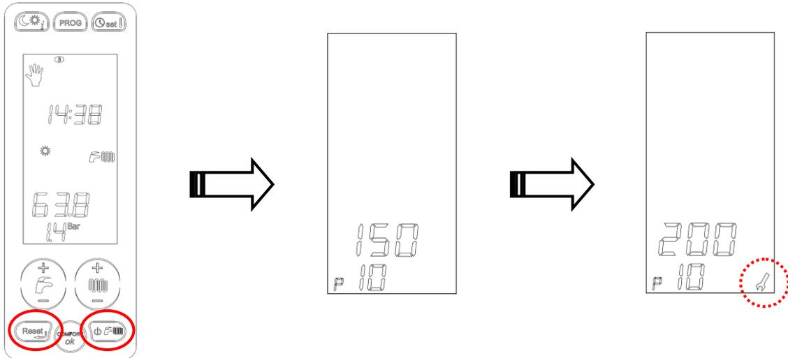
С помощью кнопок “+/- отопление”, выбрать параметр P10:
