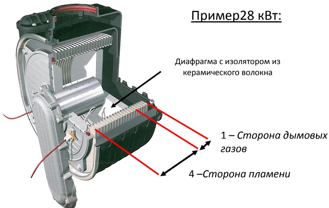
Теплообменник делится на две рабочие зоны. Первая зона (зона сгорания) состоит из нескольких элементов, в зависимости от мощности. Вторая (зона конденсации), более холодная, состоит из единственного элемента и обогревается горячими дымовыми газами, возникшими в зоне сгорания, как раз перед их выводом. Именно на этом этапе гарантируется конденсация посредством понижения температуры дымовых газов ниже порога, определяемого «точкой росы».
