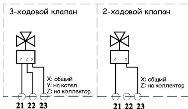
Задача котла в данном случае состоит в управлении 3-ходовым клапаном посредством многофункционального реле и включении горелки котла, когда температура горячей воды в бойлере солнечного коллектора будет недостаточно высока.
