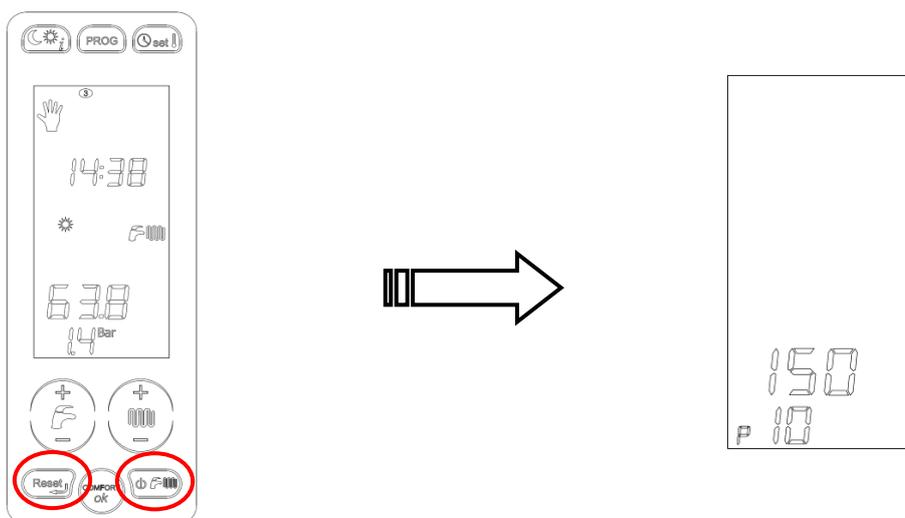
Нажатием на кнопку «ok» подтверждается изменение значения параметра, а символ разводного ключа указывает на то, что имеется возможность изменить показатель значения при помощи кнопок «+/- отопление»:
