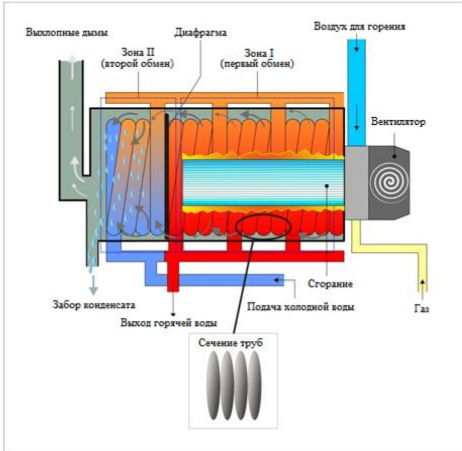
Внутри модуля обратка котла расположена в наиболее холодной части (конденсационной камере) для обеспечения конденсации водяных паров из дымовых газов и предварительного нагрева воды таким образом, чтобы температура воды была более высокой на входе в камеру сгорания. Это существенно снижает затраты топлива и позволяет избежать образования конденсата который может оседать на горелке, и пагубно сказываться на ее работе.
