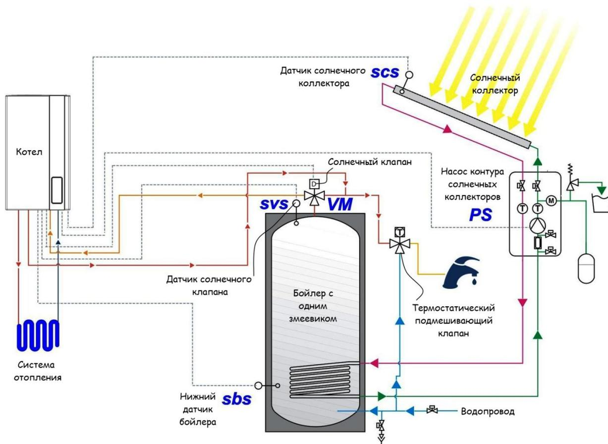
**Режим нагрева бойлера (насос солнечного контура ON)**
