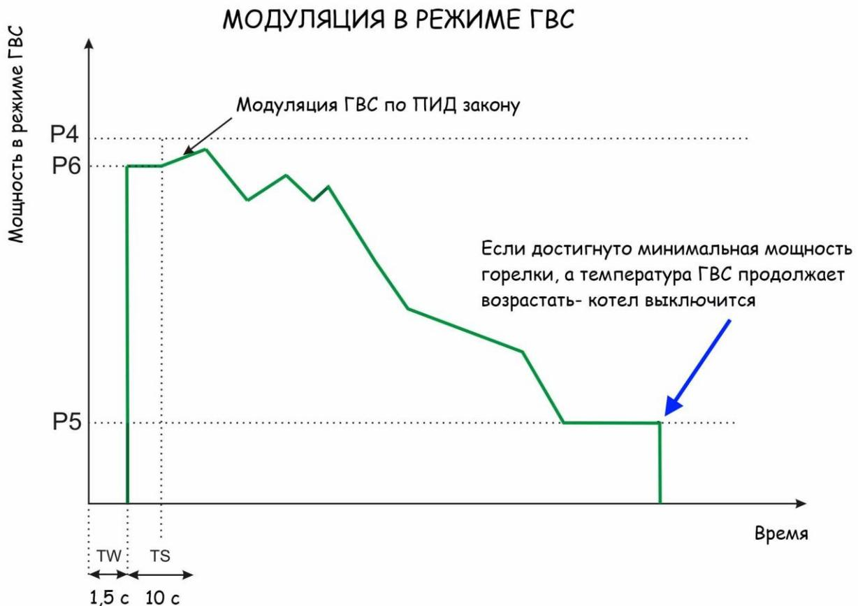
В случае плохой теплопередачи со стороны пластинчатого теплообменника, вследствие образования накипи может возникнуть риск перегрева первичного контура. Поэтому к управлению по закону ПИД регулирования добавляется еще модуляция по температуре теплоносителя. Данная функция включается при температуре подачи выше 81 °C и отключается при снижении ее до 75 °C. При наличии 2 законов регулирования, расход газа определяется как наименьшее возможное значение в данной ситуации из двух вычисленных.
