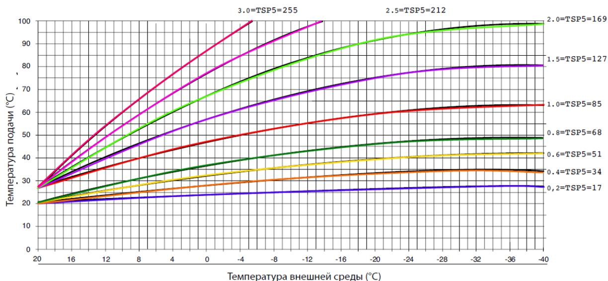
Плата самостоятельно распознаёт наличие датчика внешней температуры и включает режим терморегулирования, поддерживая температуру подачи в рамках предварительно выбранного диапазона температуры отопления (20 °C ÷ 78 °C или 20 °C ÷ 45 °C).
