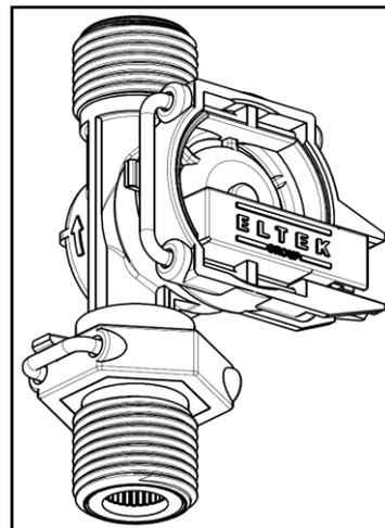
Датчик протока передает импульсный сигнал на плату управления, которая определяет соответствие между частотой импульсов и объемным расходом воды:
