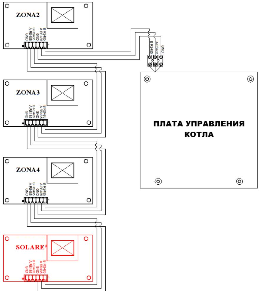
На каждой плате расширения находится переключатель, который замыкает шину передачи данных RS 485. Это необходимо для снижения вероятности пропадания сигнала обмена данными между платами вследствие слишком длинных проводов или электромагнитных помех
