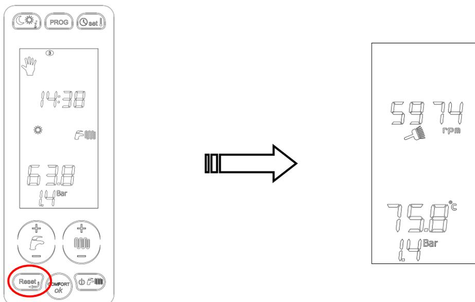
Нажимая кнопки «+ и – ГВС», возможно изменять скорость вращения вентилятора от минимального (P5) до максимального значения, определенного параметром P4. В данном случае, на дисплее появится символ гаечного ключа (индикация изменения параметра) и буква «H» что символизирует частоту оборотов вентилятора в Гц:
