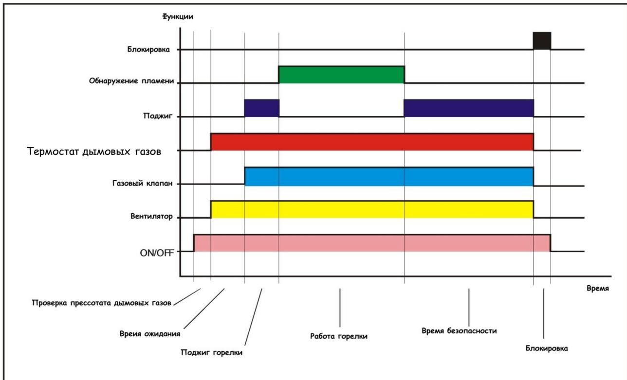
Котел блокируется по дымовым газам, если датчик и термостат дымовых газов не дают сигнал готовности к корректной работе (см. стр. 94).
