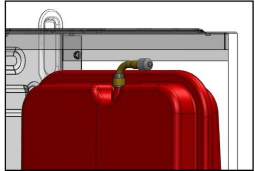
Расширительный бак расположен вертикально справа от камеры сгорания и снабжен **удлинителем** для более удобного доступа к клапану.
