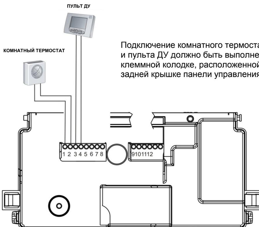
Подключение комнатного термостата и пульта ДУ должно быть выполнено к клеммной колодке, расположенной на задней крышке панели управления
